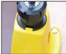
Eine schonende Werkzeugmontage (horizontal und vertikal).
