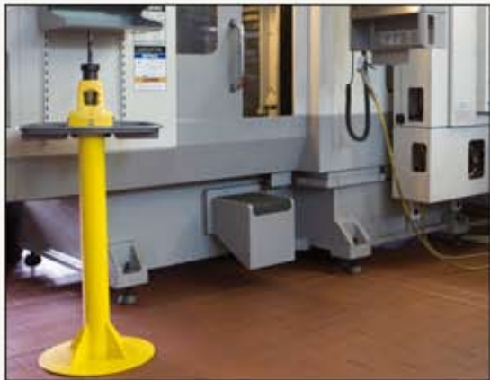
Werkzeugaufnahme mit solidem Standfuß (optional).
